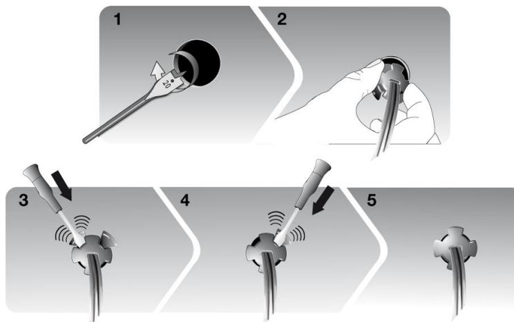
Instalación de los conectores de audio
