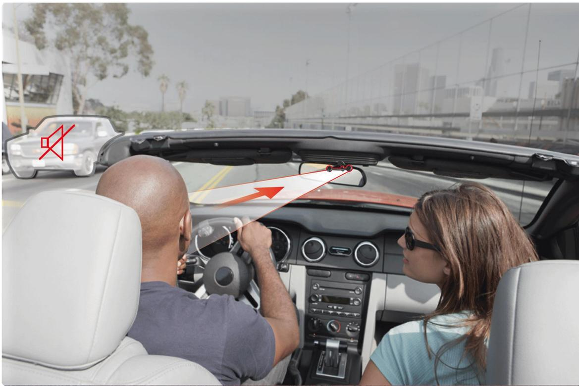
Efecto *Detección del ruido lateral* activado - Micrófono orientado correctamente
